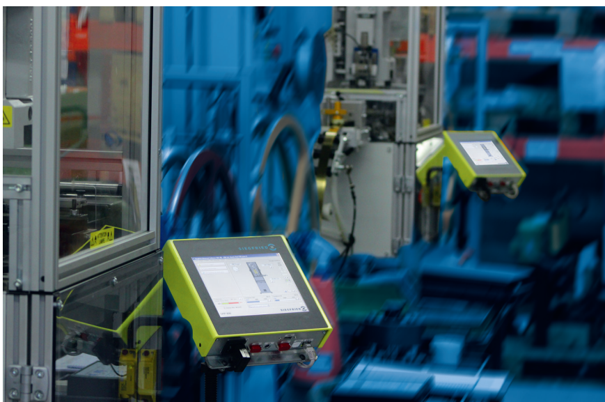
Bild 5: Anspruchsvolles Projekt für die Uhrenindustrie: Die verketteten Pressen werden von Siegfried-Terminals gesteuert
