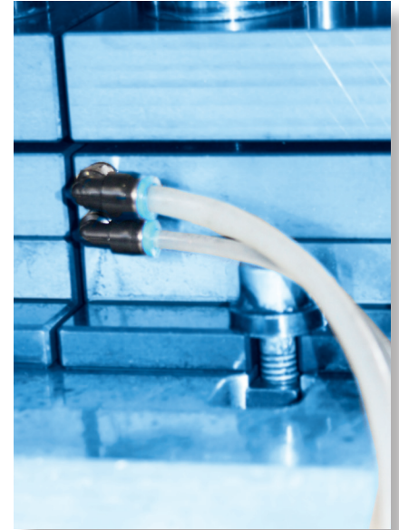
Bild 5: Problemlose Zwischenbeölung direkt im Werkzeug (Werkbilder: Heinz Siegfried AG, CH-Aarberg)
