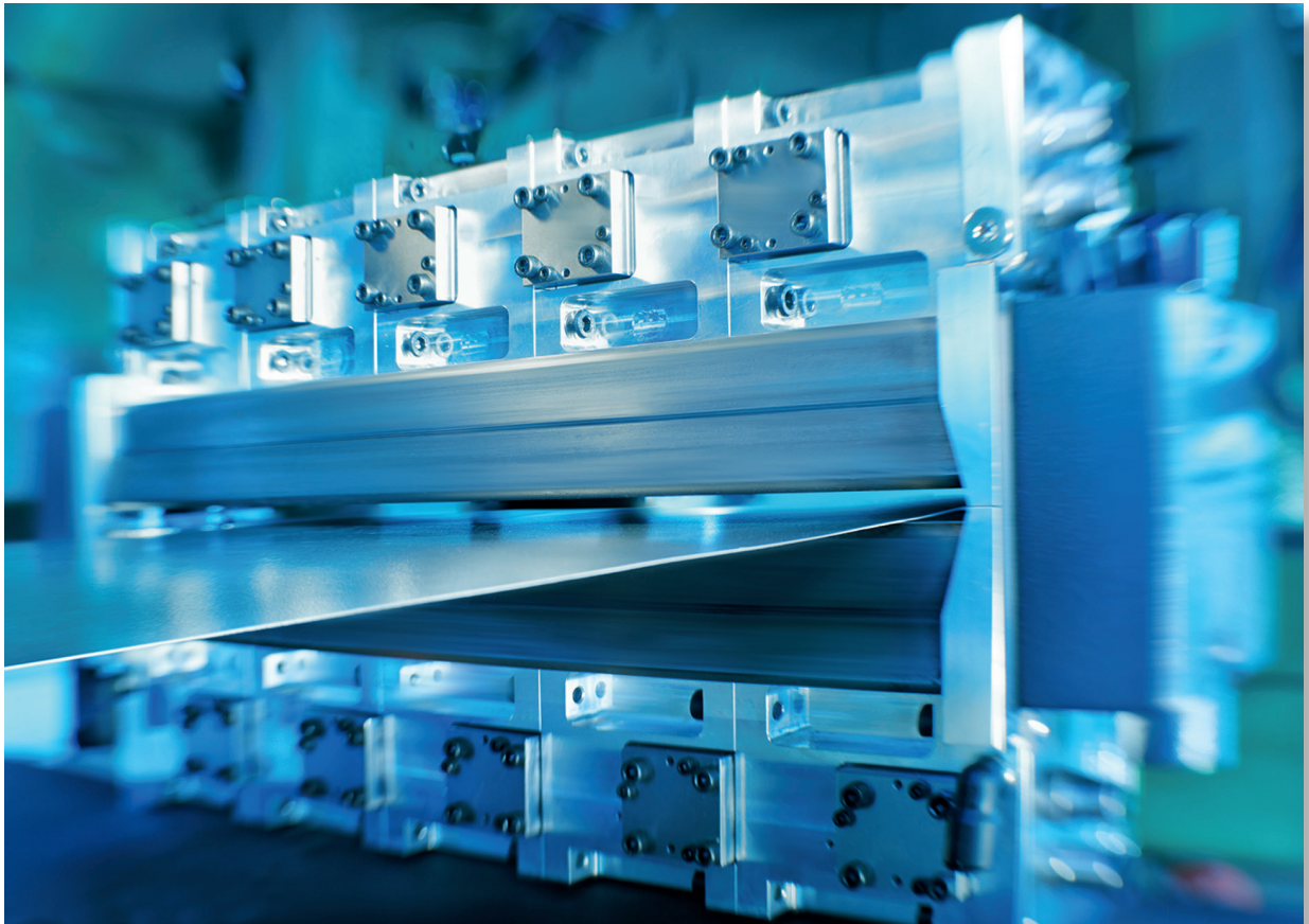
Sprühkammer aus zehn „Lube Cubes“
