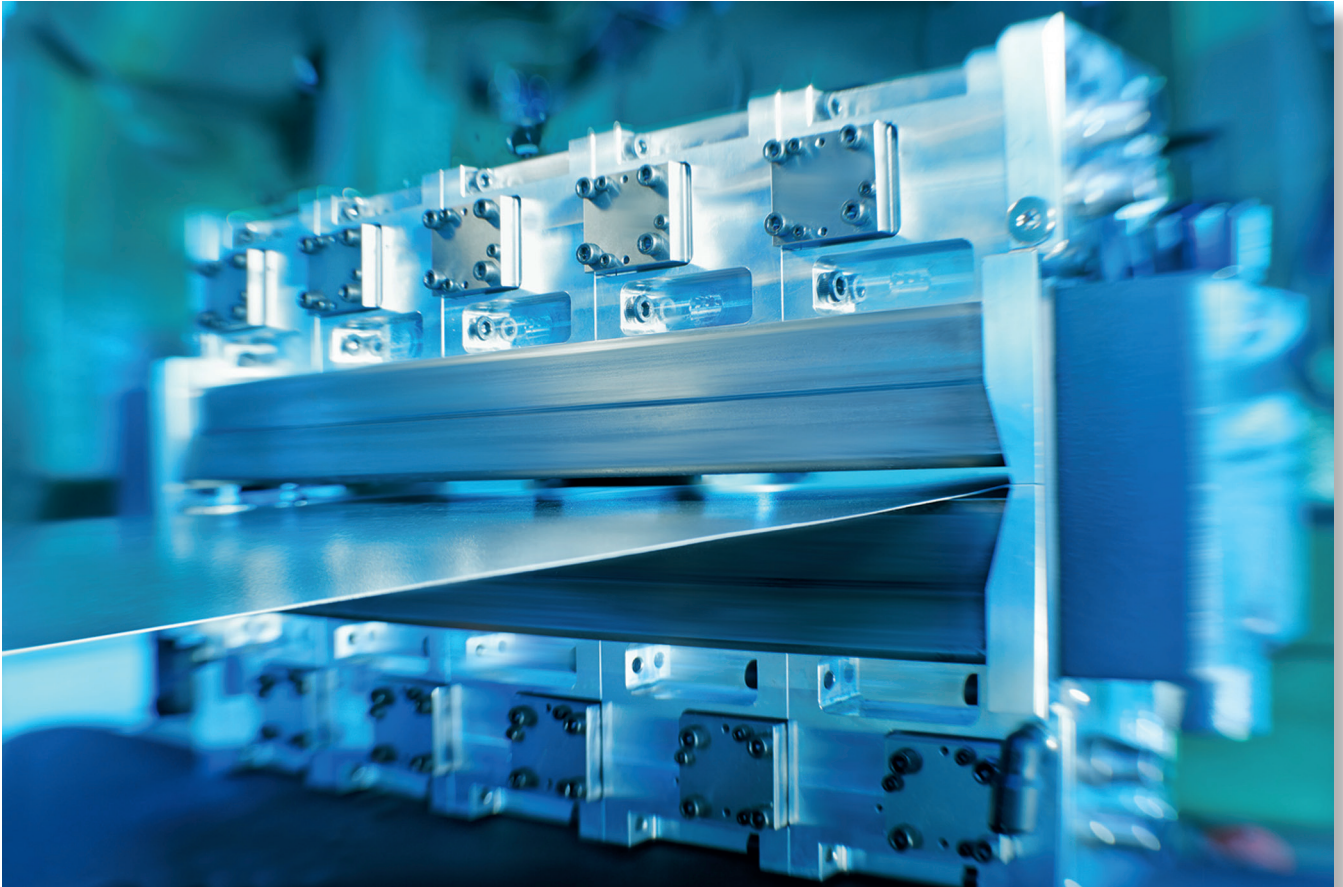
Bild 1: Sprühkammer aus zehn „Lube Cubes“
