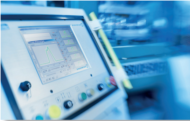
Bild 3: Einheitliche Bedienphilosophie: Mit der innovativen SAS-Software lässt sich der gesamte Stanzprozess steuern und überwachen (Werkbilder: Heinz Siegfried AG, CH-Aarberg)
